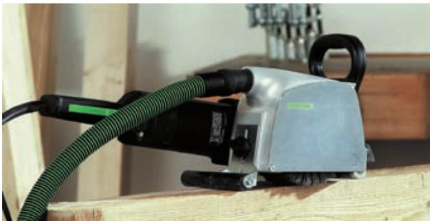
La spazzolatrice RUSTOFIX permette la rapida e facile ristrutturazione di superfici di legno – ideale nel risanamento di vecchie costruzioni e di travature.
