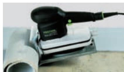
Il coltello per moquette quasi non soggetta ad usura consente un'elevata capacità di pelatura.
